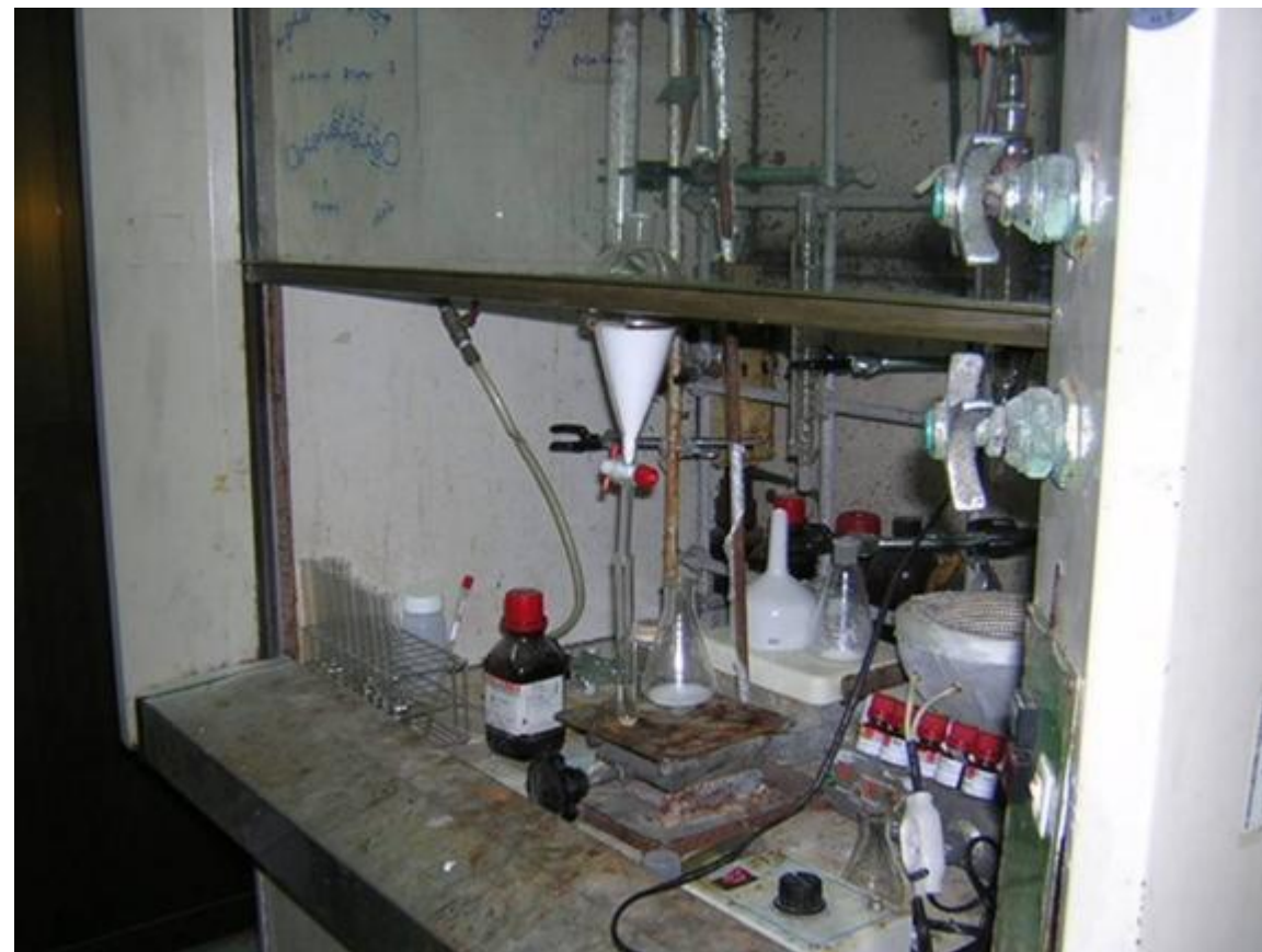
排氣櫃中過多物品，影響氣流；洩漏未清理
